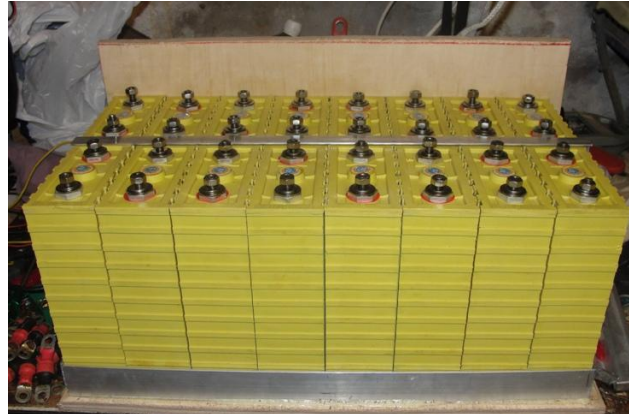
LFP accubank van 16 100Ah cellen (51,2V nominaal, maximale laadspanning 55,2V bij 3,45V per cel)
