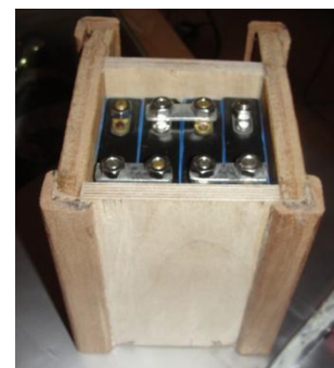
Houten accubak met 4 70Ah LFP cellen
